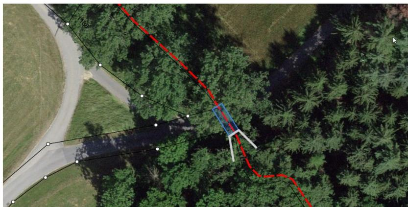
Figure 1 En bleu le nouveau tuyau, en gris l'ouvrage d'entrée avec la herse. En rouge, la limite communale.
